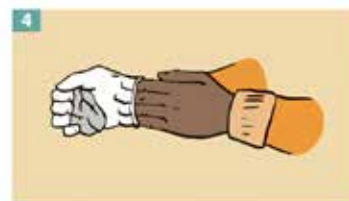
4 Con la mano que no tiene el guante, retire el segundo guante insertando los dedos dentro del mismo por la parte superior de la muñeca.
