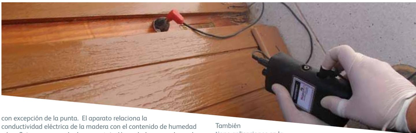
con excepción de la punta. El aparato relaciona la conductividad eléctrica de la madera con el contenido de humedad y lo refleja en una escala de porcentaje. Humedades normales en la madera de vigas y marcos están comprendidas entre el 14 y el 16 % dependiendo del tipo de madera y de la ubicación tanto geográfica como del uso al que se destine la pieza (exterior, a la intemperie, protegida, etc.).
