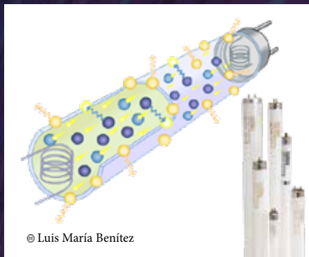
Luminarias fluorescentes y esquema de funcionamiento.
