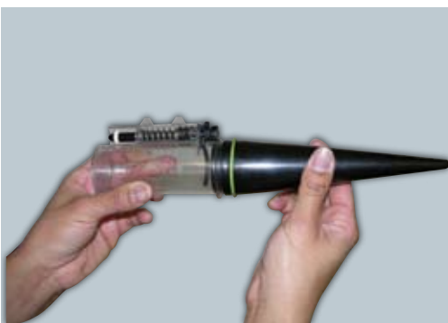
La goma de látex se coloca en el receptáculo que contiene el cebo mediante el cargador en forma de cono
