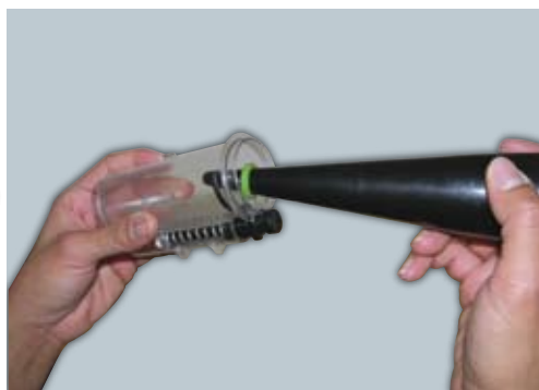
Cuando la rata toca el disparador la goma se suelta como se muestra en la foto
